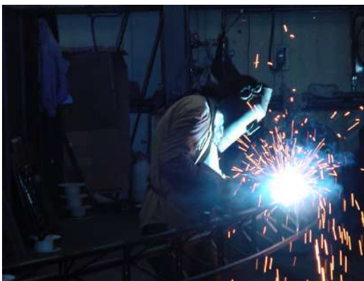
工廠內桁架式鋼支保焊接情形(圖十五)
