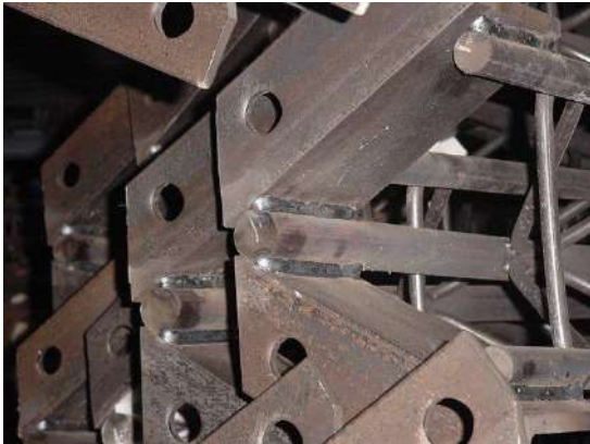
桁架式鋼支保主、副鋼筋焊接成品(圖十六)
