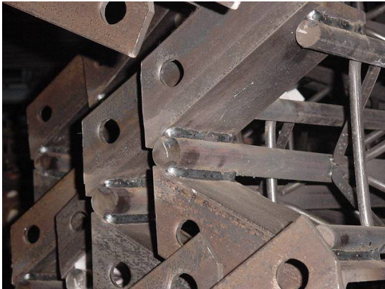
桁架式鋼支堡主、副鋼筋焊接成品(圖十六)
