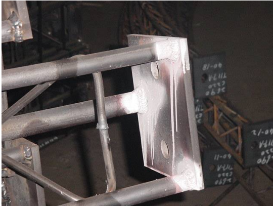
桁架式鋼支堡接合端板焊接成品(圖十九)
